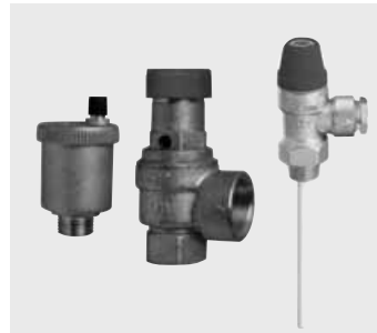
Kleppakket (421600) bestaande uit: automatische klep ontluchting, veiligheid 1,5 bar, thermische afvoer 90 °C
